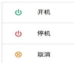
若确认要开机，单击弹出窗口的“开机”键，系统进入运行状态，主页面上机组状态显示由“停机”变成“运行”，若确认要关机，单击“关机”键，可对系统执行停机操作，系统根据逻辑关闭系统；点“取消”键可直接关闭窗口不执行相关操作。
